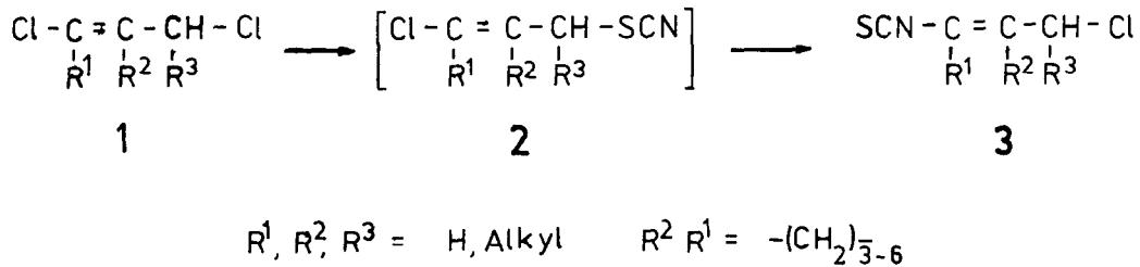
Die chlorsubstituierten Vinylsenföle 3 sind leicht aus  $\gamma$ -Chlorallylchloriden 1 über die  $\gamma$ -Chlorallylrhodanide 2 zugänglich geworden [9]. Sie sind bei nucleophilen Angriffen an der Senföligruppe geeignete Ausgangssubstanzen für 6H-1,3-Thiazine.
